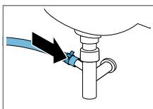
Ασφαλίστε το σημείο σύνδεσης με έναν σφιγκτήρα εύκαμπτου σωλήνα (24-40 mm).
