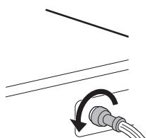
**2** Αφαιρέστε το φίλτρο εισόδου νερού με μια μικρή πένσα και καθαρίστε το φίλτρο χρησιμοποιώντας μια οδοντόβουρτσα μεσαίου μεγέθους.
