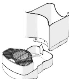
**i** Comprobar periódicamente que el cajón no esté lleno con el fin de evitar producirle daños a la cafetera o que funcione incorrectamente.
