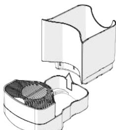
**i** Verificar periodicamente se a gaveta das cápsulas não está cheia, a fim de evitar danos e o mau funcionamento da máquina.
