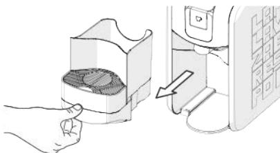
**2** Extrair a bandeja interna de recuperação das cápsulas, para retirar as cápsulas usadas.
