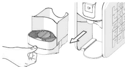
**2** Extraer el recipiente interno recoge-dosis para sacar las cápsulas usadas.
