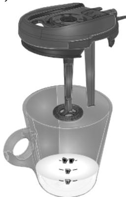
**!** Versare esattamente la dose di latte segnalata sul bricco. **NON** mettere troppo latte. **NON** mettere poco latte. In entrambi i casi si può causare la fuori uscita di latte caldo dal contenitore.
