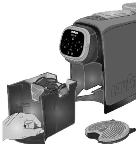
**i** Com a máquina em Stand-by, ao extrair a gaveta por mais de 5 segundos, a máquina ajusta em zero a contagem das cápsulas introduzidas.
