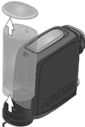
**i** Der Einsatz eines Wasserfilters (optional) verbessert die Wasserqualität und verlängert die Lebensdauer des Geräts. Nur spezielle Produkte für Kaffeemaschinen verwenden, die im Handel allgemein erhältlich sind und den geltenden einschlägigen Vorschriften entsprechen. Zum Einlegen des Filters beachten Sie bitte die Bedienungsanleitung, die dem Zubehör beigelegt ist. Was den Filterwechsel betrifft, auf die auf der Gebrauchsanweisung des Filters angegebenen Intervalle Bezug nehmen.
