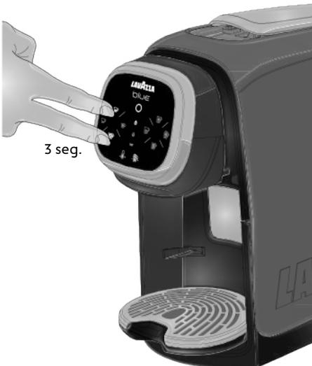
2 O aparelho emite um longo sinal acústico 🔊 e se acendem com luz fixa os botões STAND-BY ○, CAFÉ LONGO ☼ e a luz sinalizadora de descalcificação ☼.
