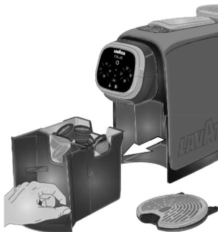
**i** Quand la machine est en stand-by, si le tiroir est retiré pendant plus de 5 secondes, la machine remet à zéro le compteur des capsules insérées.
