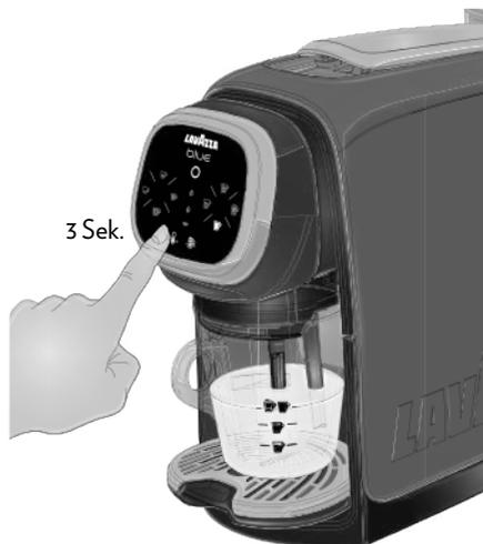
**5** Die Maschine gibt ein doppeltes akustisches Signal
