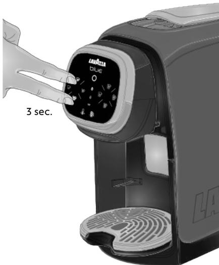
**2** La machine émet un long signal sonore 🔊 ; les boutons **ON/STAND-BY** ○, et **CAFÉ LUNGO** ☒ s'allument fixes en blanc ainsi que le voyant de détartrage ☼.
