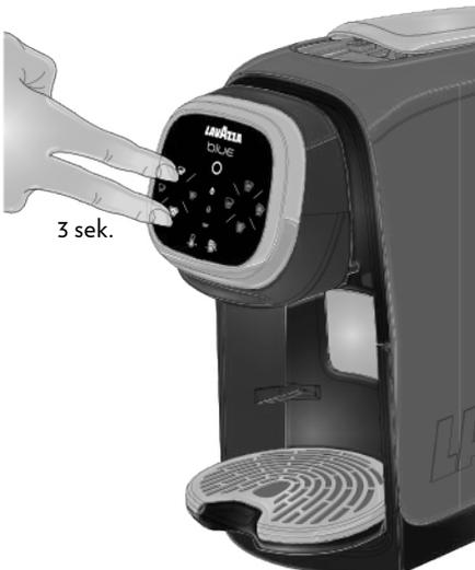
**2** Das Gerät gibt ein langes akustisches Signal ☼ aus, und die Tasten **ON/STANDBY** ○, **LANGER KAFFEE** ☼ und die Entkalkungsleuchte ☼ schalten sich mit Dauerlicht ein.
